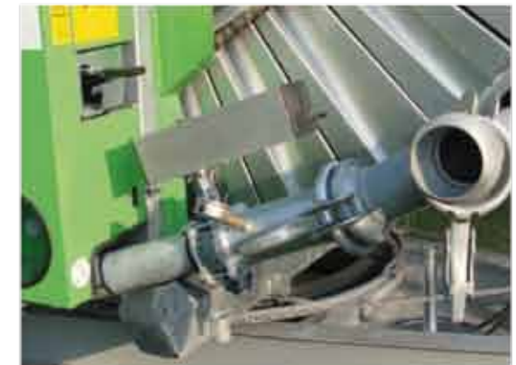
Zawór odcinający optymalne bezpieczeństwo dzięki automatycznemu wyłączaniu systemu w przypadku spadku lub wzrostu ciśnienia
