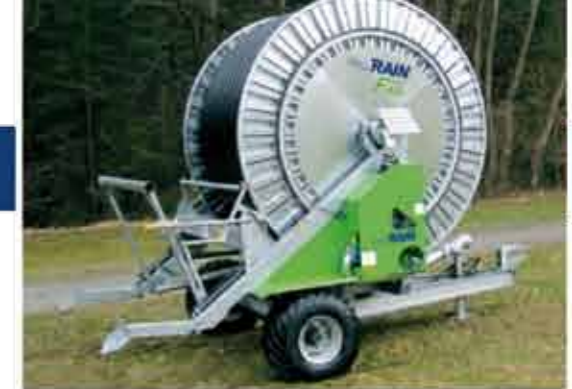
PRO RAIN kompaktowa maszyna do nawadniania różnych typów gleby
